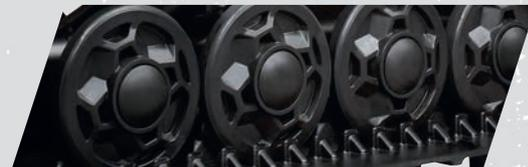
Нанесение на усиленные литые катки слоя резины, а также оригинальное расположение самих катков позволило не только снизить воздействие силы трения и вибрации, но и обеспечить надежную работу системы.
